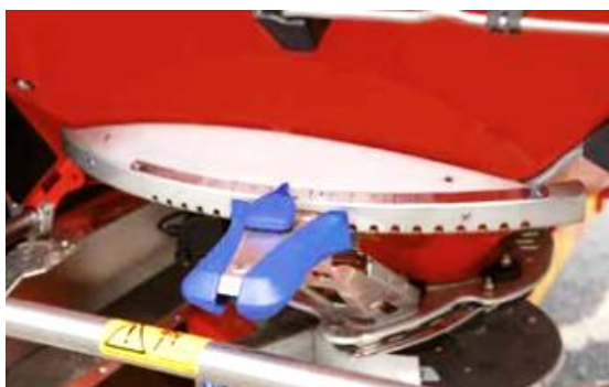
Рис. 3. Ручне регулювання точки подачі добрив
