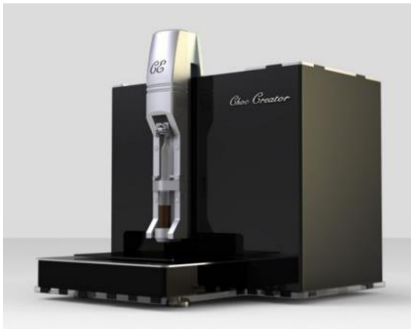
Рис.1. 3D-принтер Choc Creator 2.0 Plus, що друкує шоколадом
