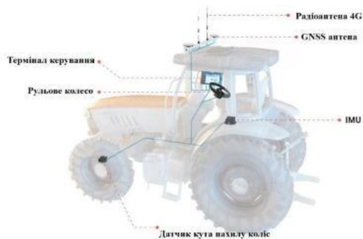
Рис. 1.1 - Система позиціювання на тракторі
