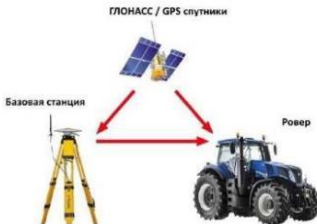
Рисунок 4 – Принцип роботи у режимі RTK
