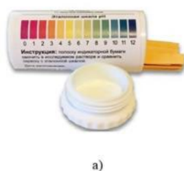
Рис. 1 – Перевірка рН антифризу: а) тест-смужки; б) перевірка за допомогою тест-смужок
