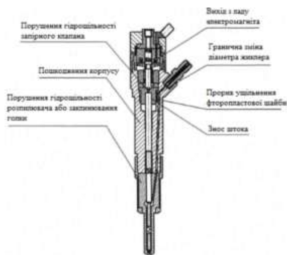
Рис. 2. Типові дефекти електрогідравлічних форсунок.
