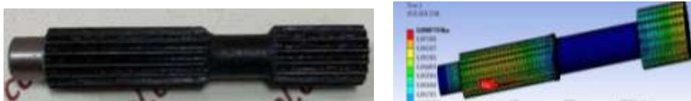
Рис. 1. Конструкція та скінчено-елементна модель валу насоса
